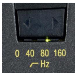
Illustration 3: Sélecteur de réduction des basses
