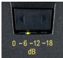
Illustration 2: Sélecteur de pré-atténuation
